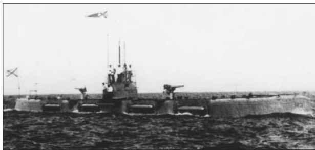
Подводная лодка «Барс», обладавшая самым мощным торпедным вооружением (12 торпед в 12 аппаратах), способная произвести 10-торпедный залп
